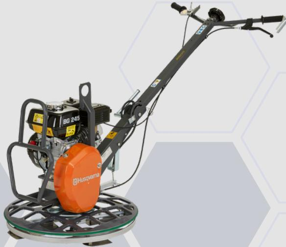
LA ALLANADORA DE CONCRETO HUSQVARNA BG244 F TWIST PITCH SIRVE PARA NIVELAR, ALISAR Y DAR ACABADO PROFESIONAL A SUPERFICIES DE CONCRETO RECIÉN VACIADAS. SU SISTEMA TWIST PITCH PERMITE AJUSTAR FÁCILMENTE EL ÁNGULO DE LAS PALETAS PARA OBTENER DISTINTOS TIPOS DE ACABADO.
